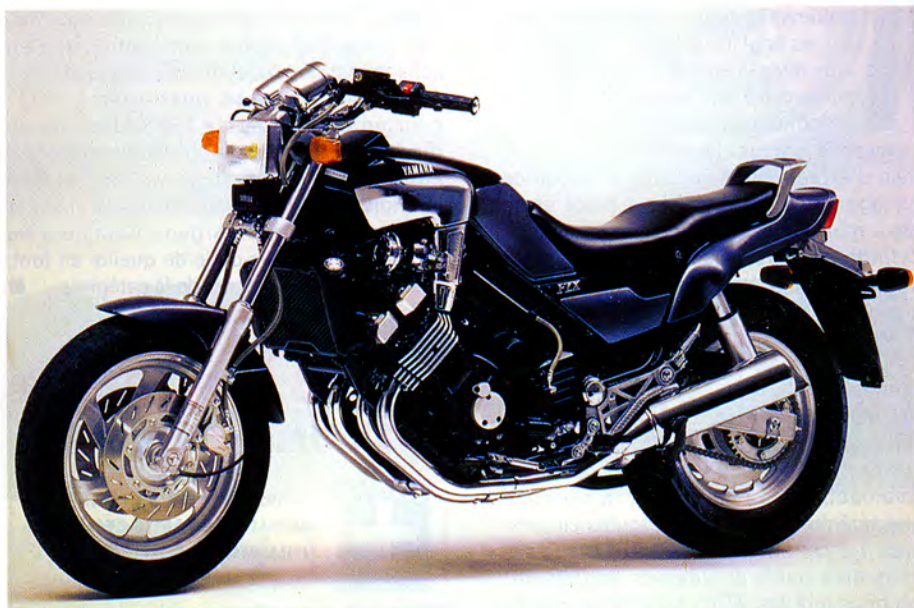
Yamaha FZX 750 "Fazer" : 4 cyl. en ligne, 20 soupapes, 749 cm 3 , 87,6 ch à 9 500 tours, 204 kg à sec, 200 km/h, 400 m départ arrêté en 11"7 et 7 l/100 km de consommation moyenne.
